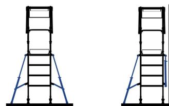
Toujours déployer les stabilisateurs. Lorsque la PIRL est placée contre un mur, un seul stabilisateur est nécessaire.
