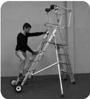
4 Stel de gewenste hoogte in. (maximum 2 niveaus per keer).
