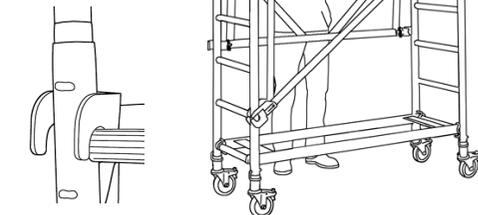
12 Dann die Verriegelung am unteren Teil auf beiden Seiten öffnen und die Haken einsetzen. Überprüfen, dass die Verriegelung unter der Sprosse liegt.
