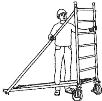
**7** Mettre la partie basse de la diagonale à l'intérieur du corps de base en contact sous la marche.
