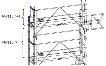
Répéter l'opération pour la 2<sup>ème</sup> console, en laissant pendre la jambe de force à l'extérieur de l'échafaudage.
