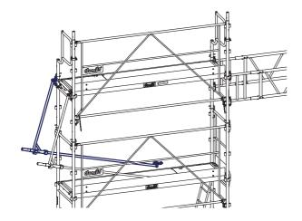
Depuis le niveau *n*, s'équiper d'un harnais et d'une longe de sécurité. Pivoter les consoles à 2 personnes. Claveter l'étrier inférieur sur le montant. Frapper les clavettes.
