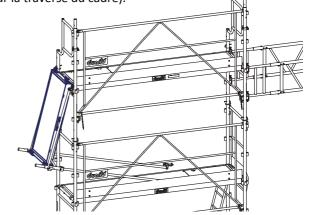
Depuis le niveau *n+1*, s'équiper d'un harnais et d'une longe de sécurité, installer le garde-corps d'extrémité bas de pente (50228), le goupiller (21000), installer les longerons / lisses (50048), installer la plinthe latérale (50130) et la plinthe d'extrémité (50138). Frapper les clavettes.
