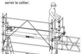
Depuis le plancher sécurisé, installer les longerons / lisses de 3m (50053). Retirer le gardecorps d'extrémité bas de pente de toit
