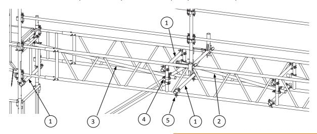
Pour la configuration d'une portée de 9m entretoiser tous les 3m maxi les membrures supérieures et inférieures avec les tubes entretoises ① (50177). Diagonaliser avec les tubes diagonales ② (50179) et ③ (50215).
