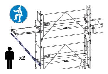
Depuis le niveau *n*, claveter l'étrier supérieur de la console longitudinale sur le montant au niveau du plancher supérieur. Laisser pendre la jambe de force à l'intérieur de l'échafaudage.
