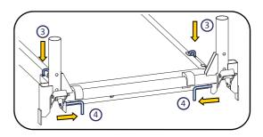
Rouler cet ensemble et accrocher le plancher sur la traverse du cadre. Vérifier le verrouillage du plancher.
