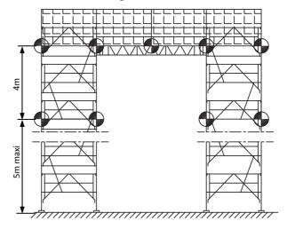
Au dernier niveau de plancher, chaque file de montants doit être amarrée.
