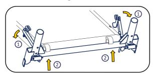
**7** Équiper le chariot d'un montant de 1m (50035), et d'un garde-corps d'extrémité pour bas de pente de toit (50228), goupiller le garde-corps et
