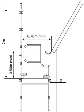
Le schéma donne la position de la protection latérale et du dernier niveau de plancher par rapport à la rive d'égout du toit.
