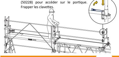
6 Monter le chariot (50235) sur l'extrémité du plancher.
