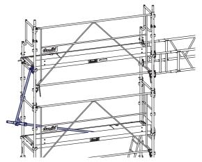
Depuis le niveau *n*, monter un longeron (50045) pour relier les 2 consoles, et frapper les clavettes . Accrocher un plancher alu-bois longueur 1,5m (50114) sur le longeron qui relie les 2 consoles (à l'autre extrémité le plancher est en appui sur la traverse du cadre).
