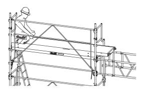
Manipuler le chariot par ses bras de fixation ①. Positionner la traverse en appui sur les crochets, l'anti-soulèvement du plancher s'escamote automatiquement ②.
