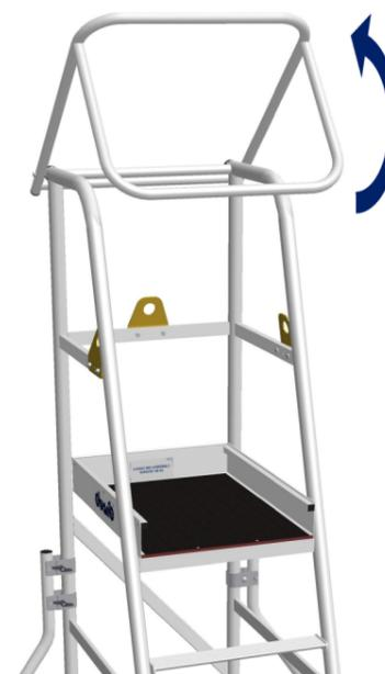
Les stabilisateurs étant déployés jusqu'au sol et bloqués, pivoter le garde-corps vers le haut pour accéder à la plateforme, puis rabattre le garde-corps vers le plan de montée.
