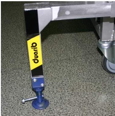
Ajuster l'appui avec la vis
