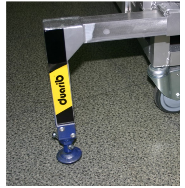
Sortir chaque vérin jusqu'au verrouillage
