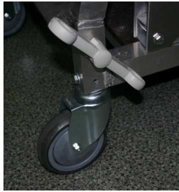
Blocage des roulettes côté accès
