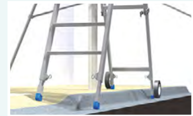
4 PIEDS RÉGLABLES INDÉPENDAMMENT POUR COMPENSER TOUS LES DÉNIVELÉS JUSQU'À 150 MM
