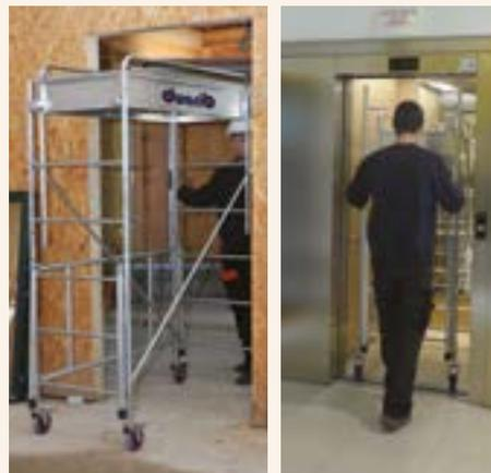
Permet de passer les portes d'une hauteur mini de 2,04 m, largeur 0,83, sans retirer le moindre élément.
