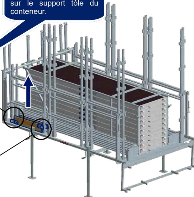
La fixation supérieure de la plinthe vient en appui sur le tube carré du conteneur.
