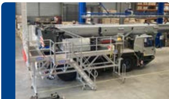
Plate-forme pour maintenance sur grues mobiles automotrices routières
