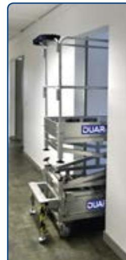
Largeur 0,71 m permettant le passage des portes de 0,83 m
