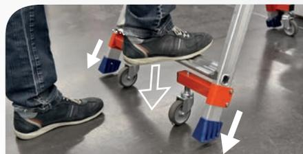
Dès la **montée**, la pression opérée fait descendre la plate-forme et le **roulage devient inopérant**.
